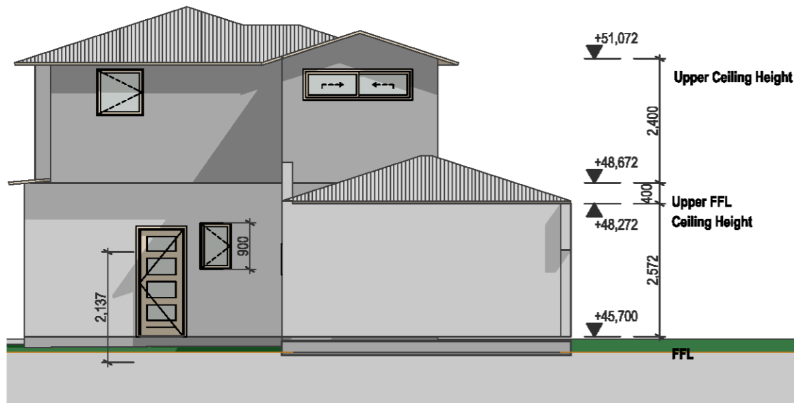
E113 UNIT D WEST ELEVATION 1:100
