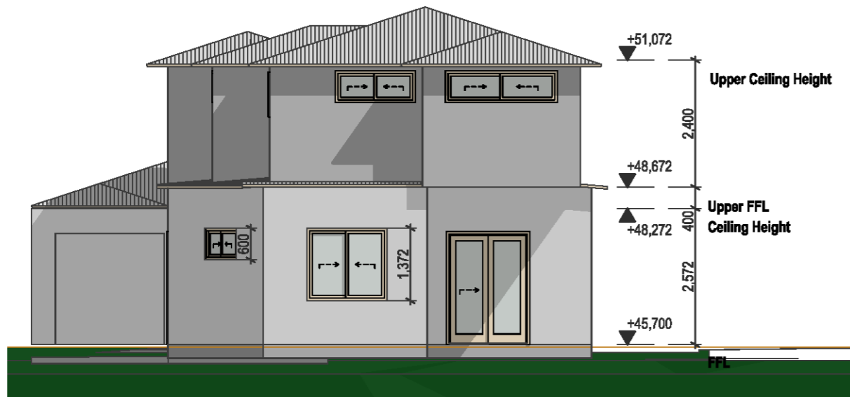
E115 UNIT D EAST ELEVATION 1:100
