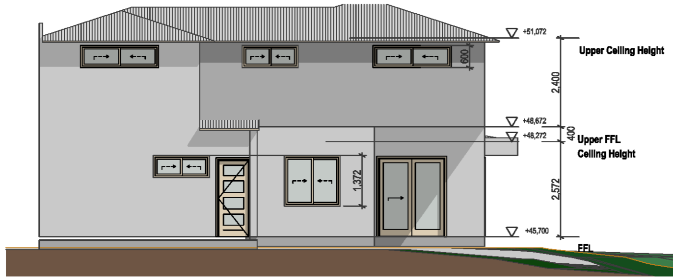
E100 UNIT A NORTH ELEVATION 1:100
